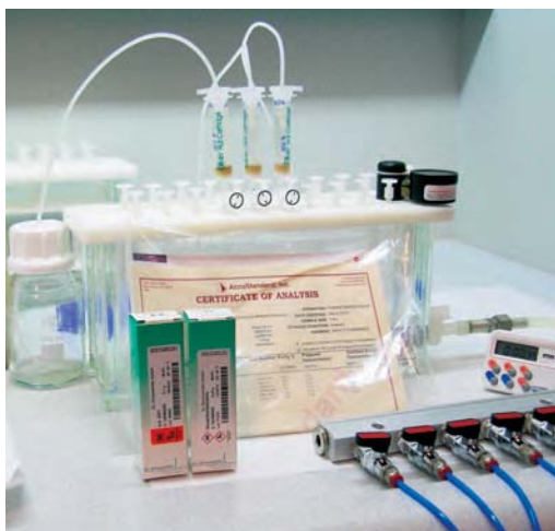
Foto 12.1. Detalle del sistema de extracción de compuestos
