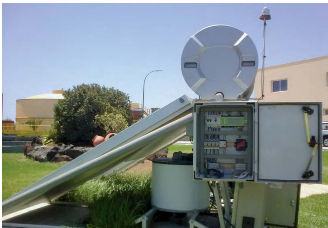
Foto 9.2. Vista lateral del prototipo de solar térmica para desinfección monitorizado en el proyecto
